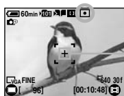
Zameriavací krížik pre bodové meranie/ Zamerajte na túto časť objektu
