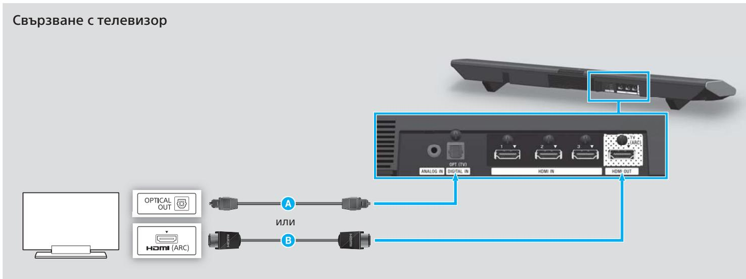
Ако телевизорът, който трябва да се свърже, не е оборудван с извод за оптичен аудио изход, свържете HDMI кабел (не е включен в комплекта, високоскоростен тип) към извода на HDMI входа с обозначение „ARC“. Ако към този извод е свързано друго устройство, изключете го и свържете тази лентова колонка с високоговорители.
